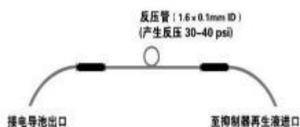
图 3-2 反压管连接示意图
