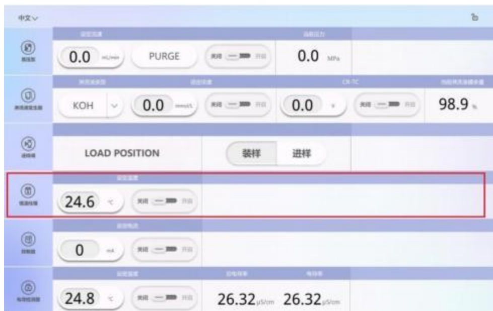
图 3-8 柱温箱的控制面板
